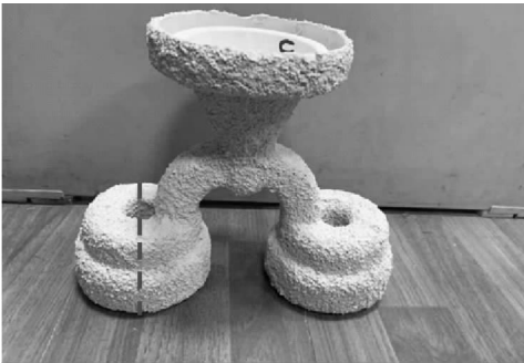
图 5 厚壁圆角陶瓷型壳
