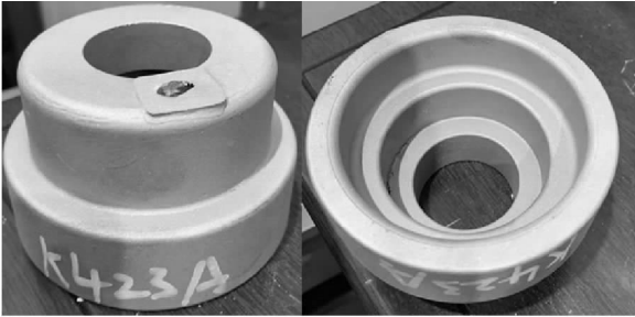
图 7 K423 高温合金浇注圆角铸件
